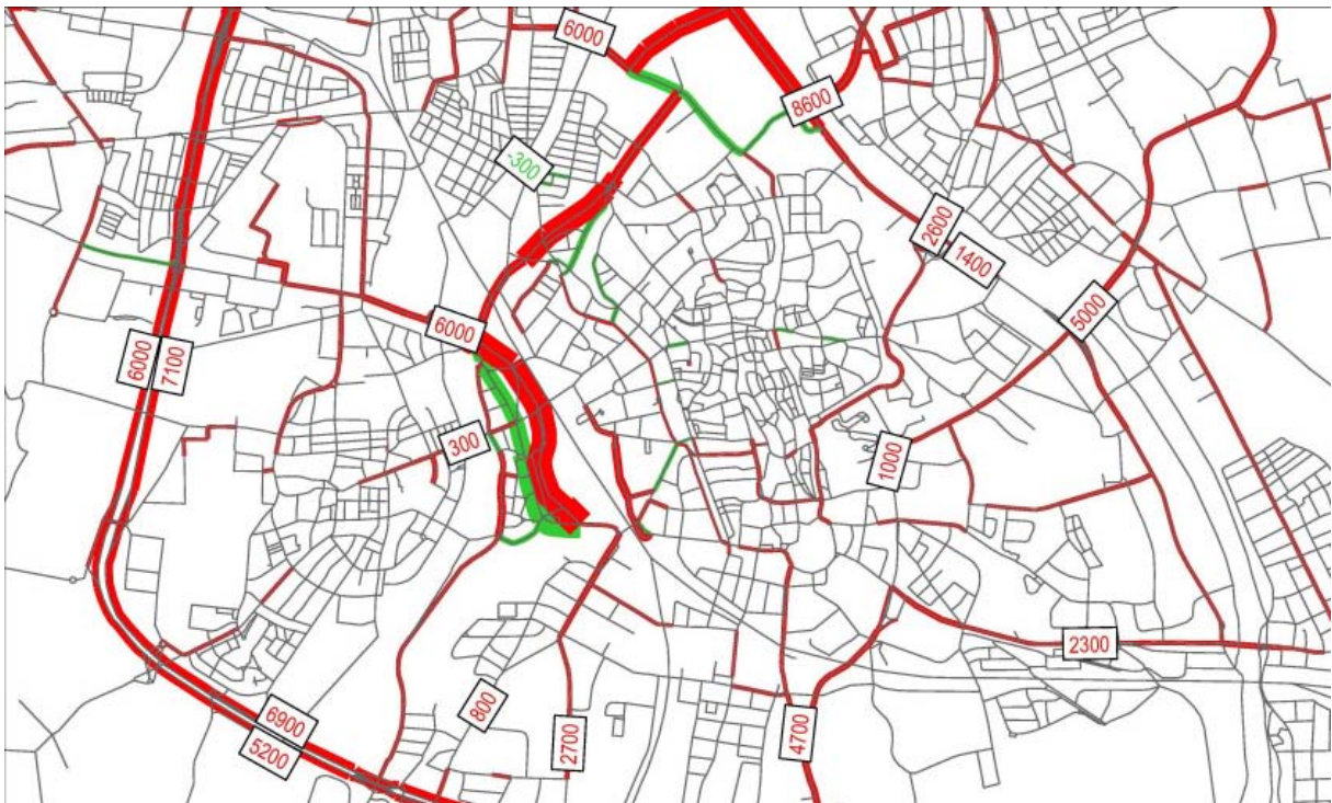
Abb. 21: Differenzbelastungen Prognose-Nullfall 2025 zu Analyse-Nullfall 2010 – Gesamtstadt [Kfz/ 24h]
